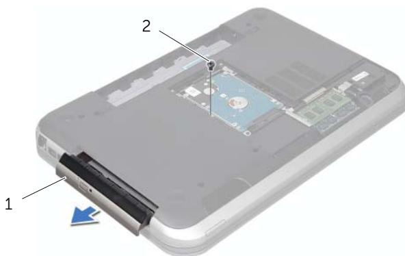
1 Ensamblaje de la unidad óptica
